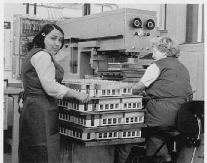
Hier werden auf die Wagen die Beschriftungen aufgedruckt.
