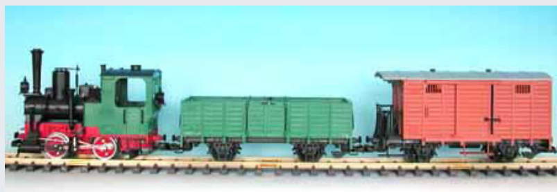
Güterzugpackung (LGB-Nr. 20401), bestehend aus Dampflokomotive 2010 mit grün durchgefärbtem Führerhaus und „Heuler“-Motor, Güterwagen 4030 in braun und 4021 in grün. Schienenkreis aus Aluminium-Schienen, Figuren, Anschlusskabel und Anleitungsheft. Erste Ausführung von 1968.
