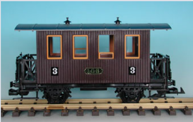
Personenwagen der Niederösterreichischen Landesbahn (LGB-Nr. 3000), Wagenkasten in Holzbeplankung, braun, verchromte Stahlachsen. Baujahr 1968.
