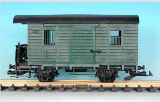
Gepäckwagen der Zillertalbahn (LGB-Nr. 3019), Wagenkasten aus dunkelgrün durchgefärbtem Kunststoff, Korbbogendach, ohne Beschriftung, verchromte Stahlachsen. Baujahr 1969.
