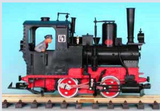
Tenderlok Nr. 4 der Hüttenwerke Siegerland (LGB-Nr. 2040), Kessel und Armaturen mattschwarz, schwarzes Führerhaus aus Hartplastik, Chassis rot eingefärbt, Stromabnahme System Schnabel (Heuler-Motor). Baujahr 1968.
