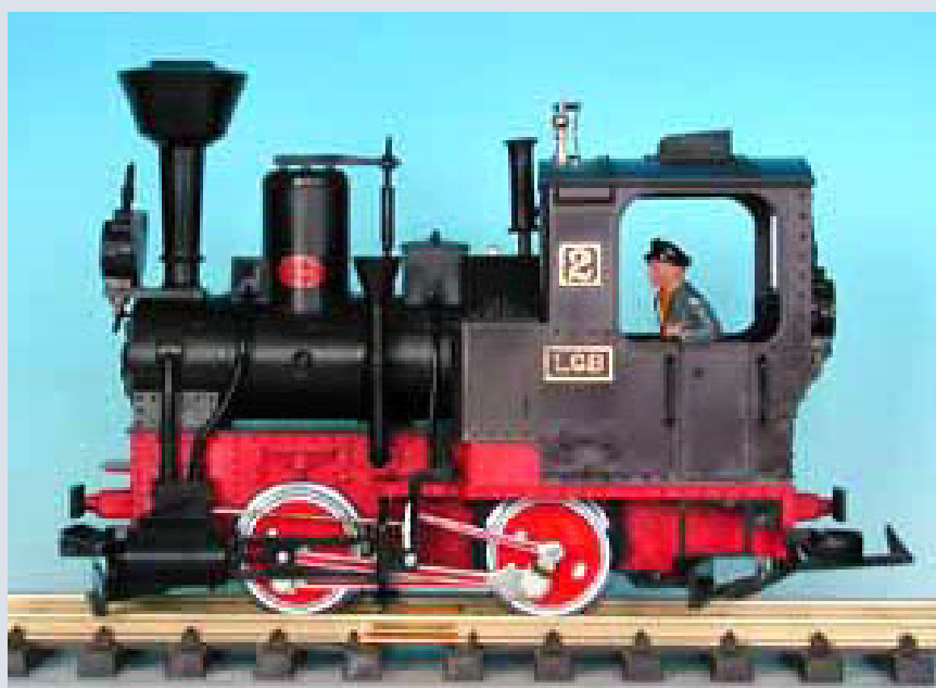
Tenderlok Nr. 2 der Steiermärkischen Landesbahn (LGB-Nr. 2020), Kobelschornstein, Kessel und Armaturen mattschwarz, braun eingefärbtes Führerhaus aus Hartplastik, Chassis rot eingefärbt, Stromabnahme System Schnabel (Heuler-Motor). Baujahr 1968.
