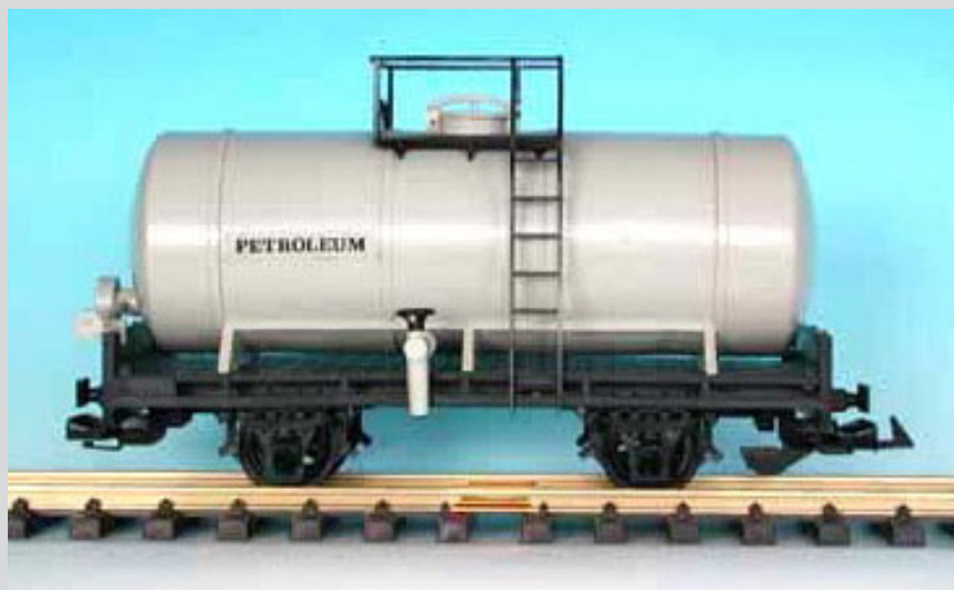
Kesselwagen der Zillertalbahn (LGB-Nr. 4040), Tank aus grauem, durchgefärbtem Kunststoff, Aufschrift „Petroleum“. Baujahr 1969.
