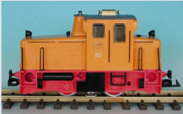
*Schöma Diesellok CFL 150 in gelb mit eingebautem Horn (LGB-Nr. 2060H). Hinter der zweiten Achse ist der kleine Stift zu sehen, mit dem das Horn ausgelöst wurde.*
